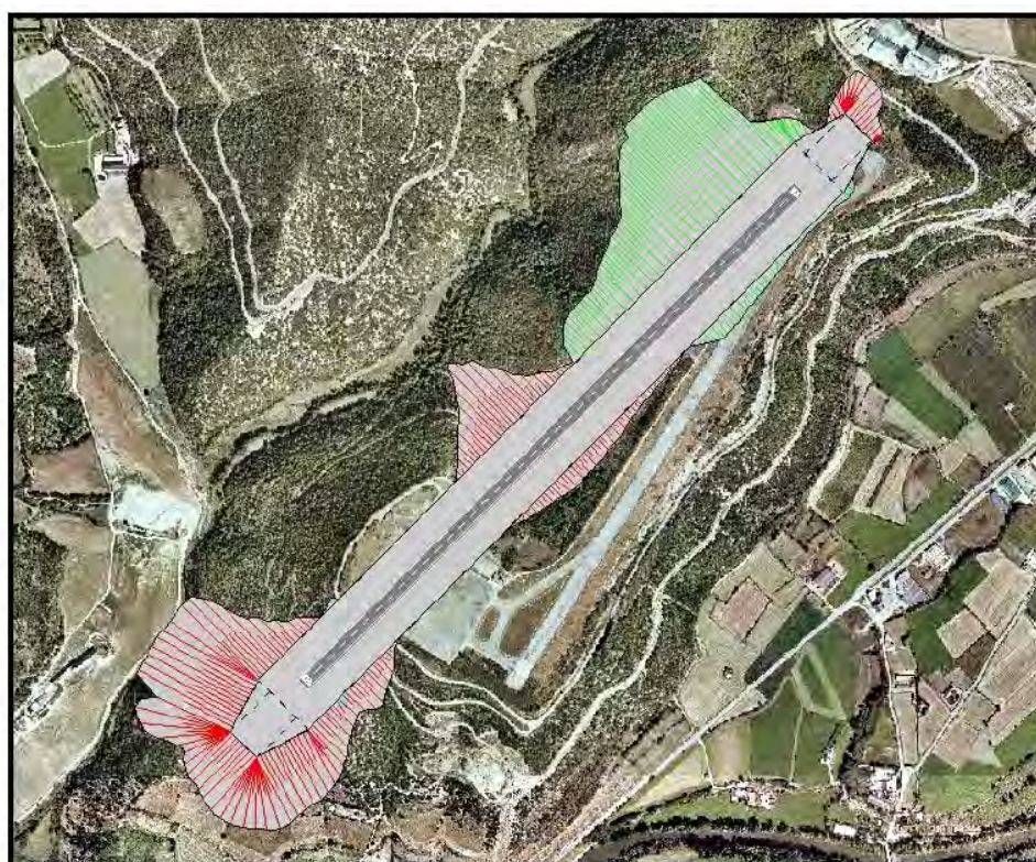
Figura 56. Encaix de l'alternativa A1 (terrapienat en vermell i desmunt en verd) Font: INYPSA
