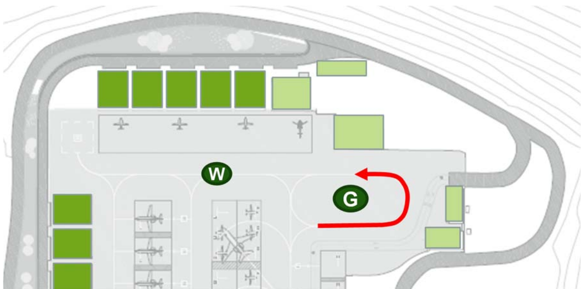
Figura 13. Maniobra per al subministrament de combustible
